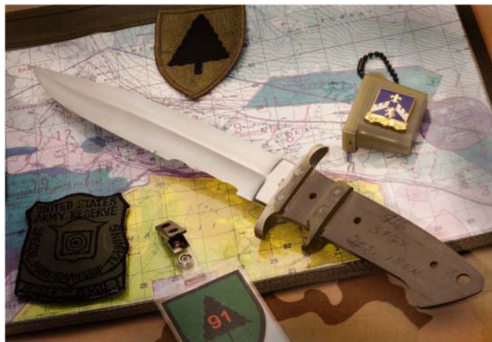
1980年代前半に作られたビッグベアーのブランクがこれだ。グラインディングのあとに強度チェックをした際、削り込みすぎてエッジが脆くなってしまう、「悪い見本」として、長くショップの壁にぶら下げてあったモノ。この後、グラインディングホイールの径を6インチから8インチに変えて改良した。
