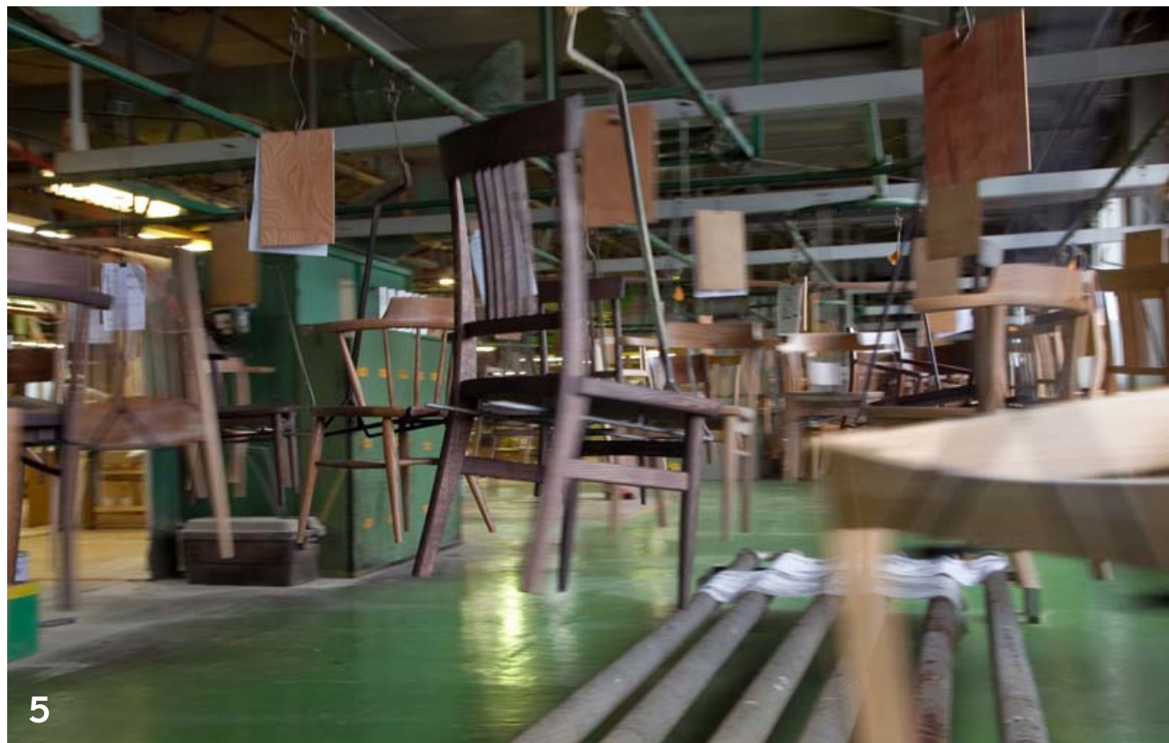
5.「飛騨スペック」とも言うべき木工連合会認定7社のうちのひとつ、柏木工の工場内で見つ、まるでダンスをしているかのような椅子の製造ライン。種類の違う椅子の塗装を効率的に行う。職人性と機械化の絶妙なバランスが飛騨の家具製造。
