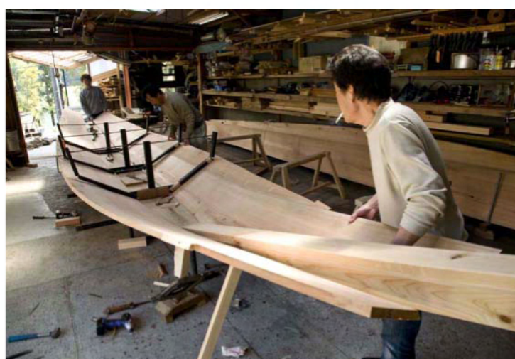
この日造っていたのは、熊野速玉大社の御船祭の先導船となる早船。水押し部分が大きな川船だ。曲げてはぎ合わせたとき、板どうしがきちんと密着するかどうかが船のよしあしの基本となる。
