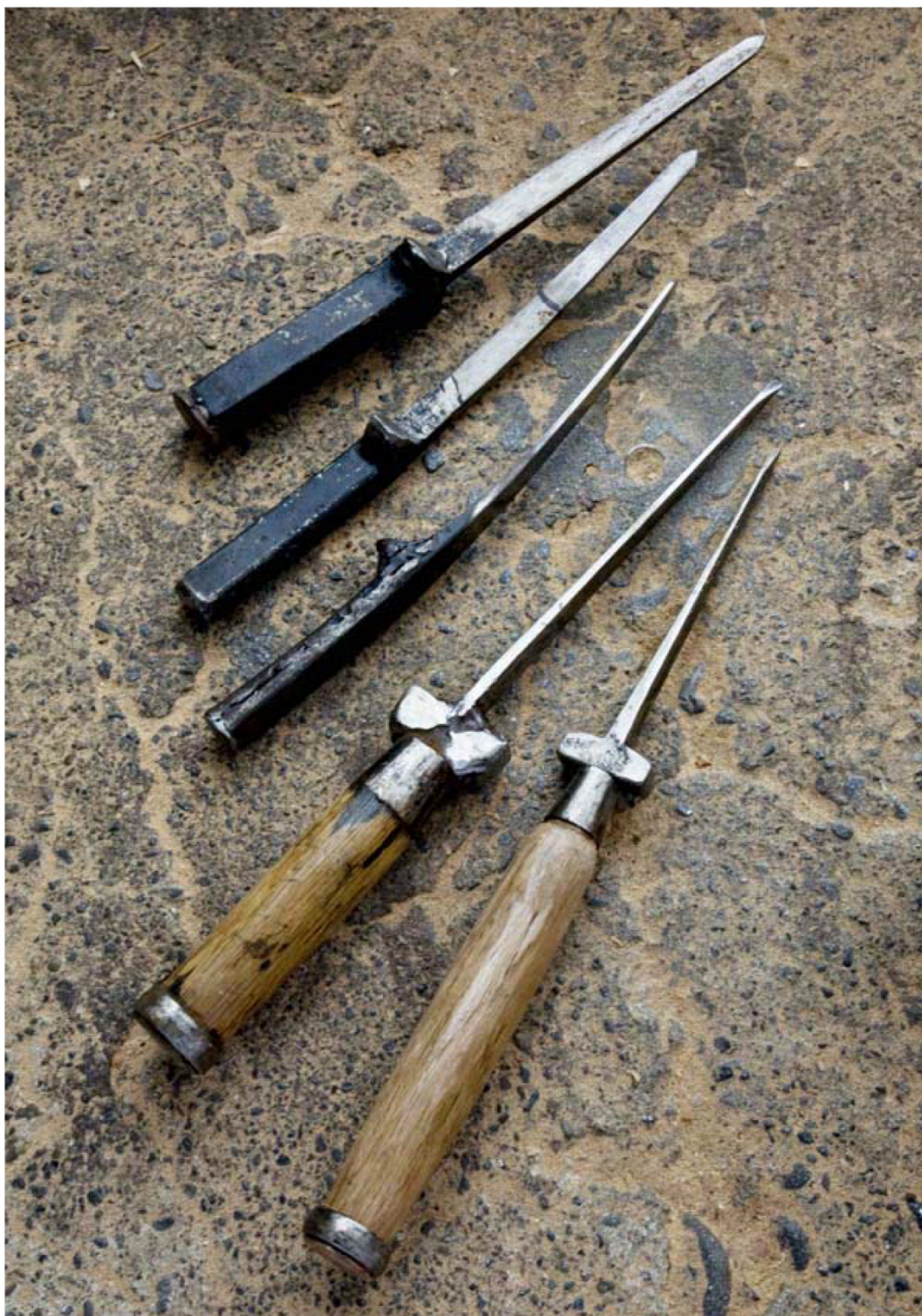
鋸盤。上3本はシキ(底板)をはぎ合わせるヌイと呼ばれる船造用のもの。片鋸で、本体は微かに湾曲している。下の両鋸のものは立ち上りの大きな部分をはぎ合わせるためのもの。
