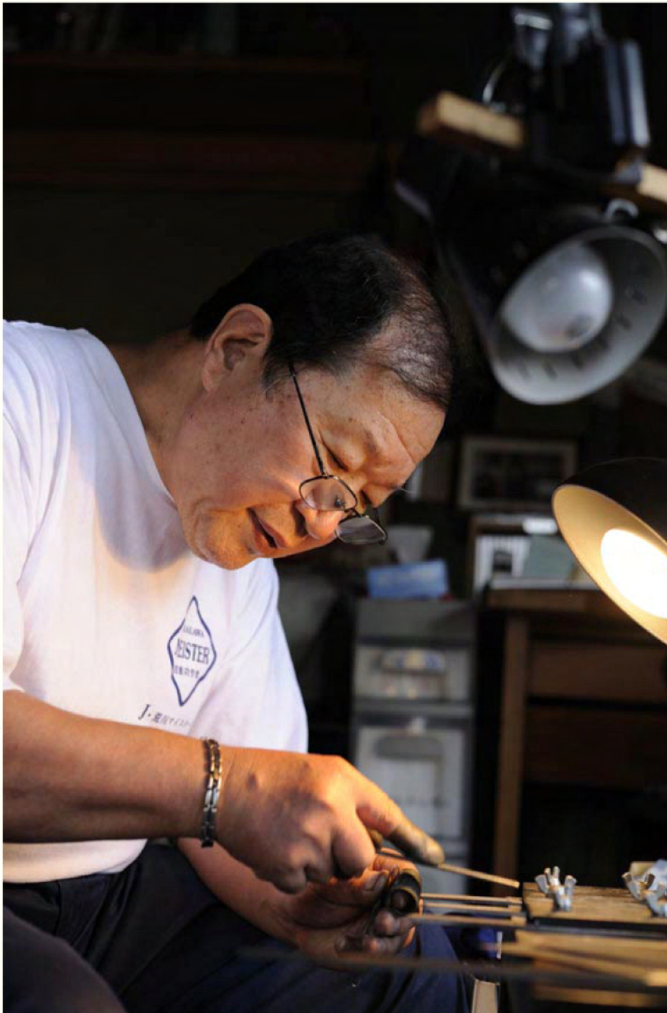
口のすりあわせには、十分に手をかける。この工程を終えると刃同士がぴったりと合わさり、挟んだ毛が切れない「毛抜き」が完成する。
