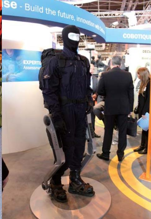
フランス国防省、DGA（装備調達庁）が中心となって開発中の二足歩行用重量物キャリアリングシステム“ヘラクレス”のプロトタイプ。ロッキード・マーチン社のHULC（Human Universal Load Carrier）と同じコンセプトだ。ハーネスと脚部を支える補助脚が一体化されており、4km/hで最大5時間、20kmの距離を踏破できる。
