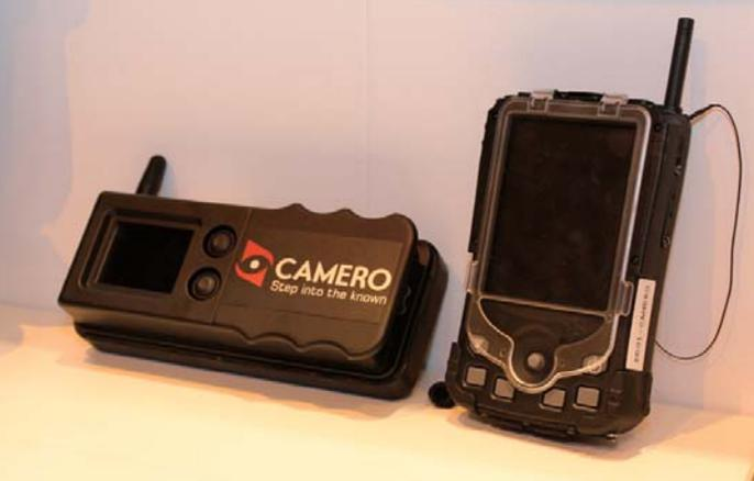
イスラエルのカメロ社の監視視レーダー“エクサバー100”。M16の30連マガジン2本と同じサイズで、重量は550g。個々の兵士が携帯できるサイズだ。従来型のこの種のレーダーは移動物しか探知できなかったが静止している人物も特定できる。探知距離は8m、探知角度は上下とも120度となっている。使用周波数は3～10GHz。
