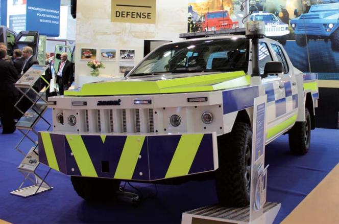
フランスのアクマット社が開発した治安用ピックアップ“ALTV4×4”。戦闘重量が3.7tで、ペイロードが1.3t。乗員はキャビンに4名、荷台に6名搭乗できる。エンジンは190馬力のディーゼルエンジンを搭載しており、最大速度は160km/h、登坂力は80%。サイレンや回転灯など多数の警察用のオプションが装備されている。写真にはテレスコープマストにタレス社の光学・電子監視システムが搭載されている。
