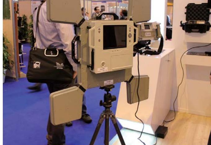
“エクサバー800”は、このタイプの製品では世界初の3D方式。平面的な2D方式に比べてより詳細に壁を通した室内の様子がわかる。2Dの探知モードも有している。探知範囲は最大20mで、使用周波数は3～10GHz。
