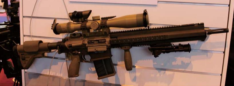
H&K社の新型狙撃銃“G28”。民間用の競技用ライフルであるMR308をベースに開発されたセミオート狙撃銃。レールマウントを装備したフォアグリップ兼スリーブがフラッシュハイダーまで伸びているのが特徴的。重量は7.9kgで7.62mm NATO弾を使用し、バレル長は420mm、初速は780m/s、マガジンは透明で装弾数は10発。2段階のガスレギュレーターを採用し、フィールド・ストリップングには特殊な工具を必要としない。パーツの75%がHK417と共用である。最大射程は800mで、サイトは3-20×50倍のスコープを搭載している。
