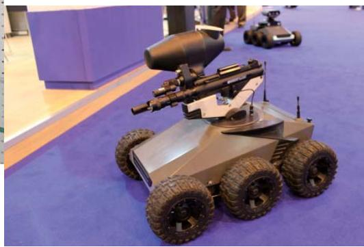
テクノロボット社のUGV“ライオットボット”。暴徒鎮圧用UGVで、ペッパーボールガンを装備している。姉妹品には同じ車体を利用し、光学センサーを装備した“ビジョンボット”が存在し、2種類を連携して使用すれば有効に偵察と暴徒鎮圧が可能である。
