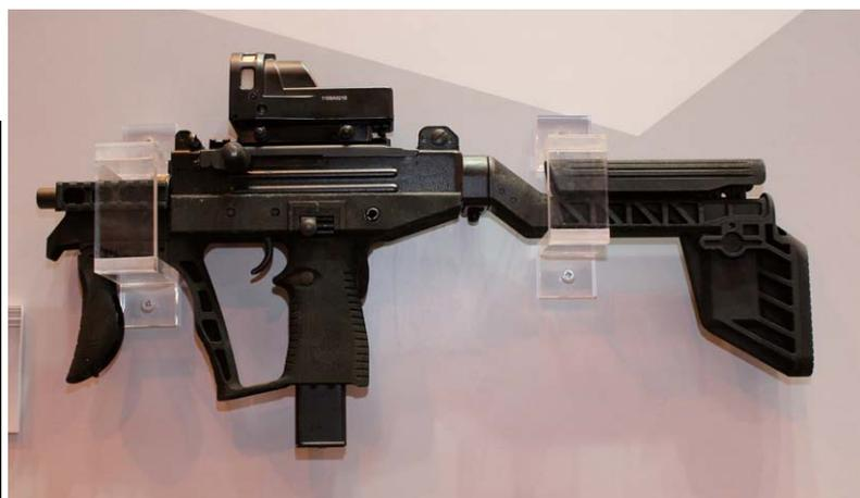
イスラエルの小火器メーカー、IWH社の新製品“UZIプロ”。マイクロUZIの後継モデルで、ポリマー製のフレームを採用している。同じく折りたたみ式ストックもポリマー製で、チークパッドはアジャスト式。トリガーガードはなく、代わりにステアアUGのようなグリップ/フレーム一体型のガードが設けられている。フレームはバレルを包み込み形で延長されており、サイレンサーが装着できる前掲の設計となっている。ピカニティニ規格のレールマウントが左右に設けられ、下部には折りたたみ式のパーチャルグリップが装備されている。サイトにはマプロ社の“マプロ21リフレクトサイト”を採用。使用弾薬は9mmパラベラムで、重量は2.32kg、全長は529mm（ストックを畳んだ状態では300mm）、バレル長152mm、初速380m/s、発射速度は毎分1050発となっている。
