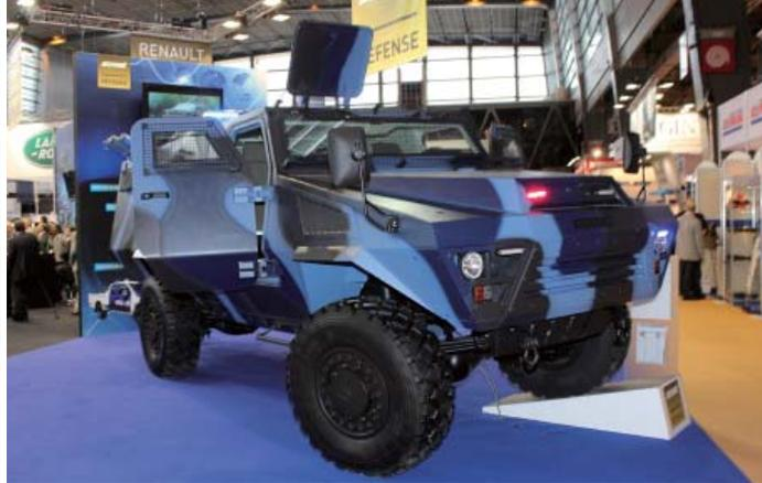
アクマット社の治安用装甲車“バストンAPC”。仏軍でトラック兼兵員輸送車として使用されているVLRAをベースに開発された装甲車だ。最大戦闘重量が15tで、ペイロードが最大2t、装甲はレベルI～IIIからユーザーが選択できる。乗員は2名+下車歩兵となっている。215馬力のディーゼルエンジンを搭載し、最大速度が120km/h、後続距離は1,000kmとなっている。
