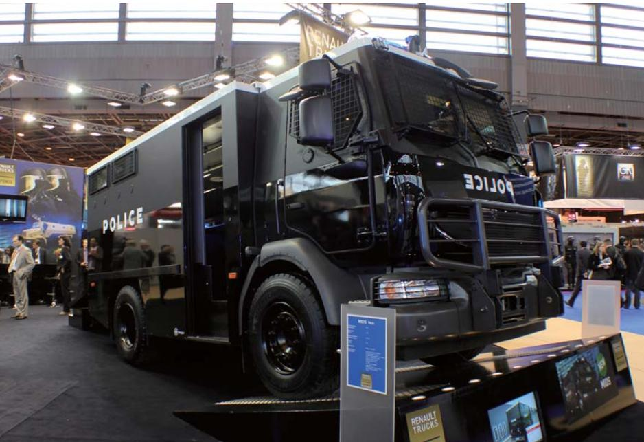
ルノー・トラック・ディフェンス社が発表した新型の治安車輛“MIDS”。SWATチームなどの展開や暴動鎮圧などを想定した装甲バンで、戦闘重量が17.5t。300馬力ないし200馬力のディーゼルエンジンを搭載する。乗員は2名+10名の下車要員で、キャビンは各種装備も収納できる。エアコン、飲料水タンクが標準装備されている。またドーザーを装備することも可能だ。
