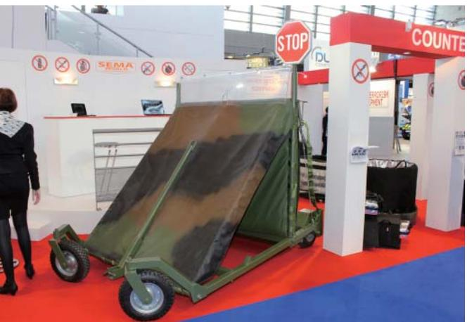
フランスのSEMAワールド社の対RPG防衛システム“NAウォール”。折りたたみ式で、RPGだけでなく、車輛爆弾などにも有用である。
