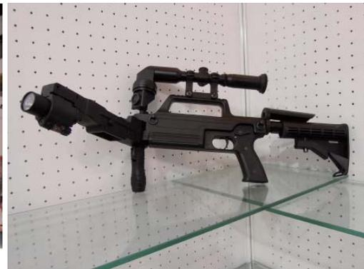
中国のジーファ3502キャリアー・アピール社が発表した曲射銃システム。イスラエルのコーナーショットそっくりだが、バリスコープが装備されているのが特徴。ビデオカメラと液晶のモニターを使用するよりも安上がりだ。
