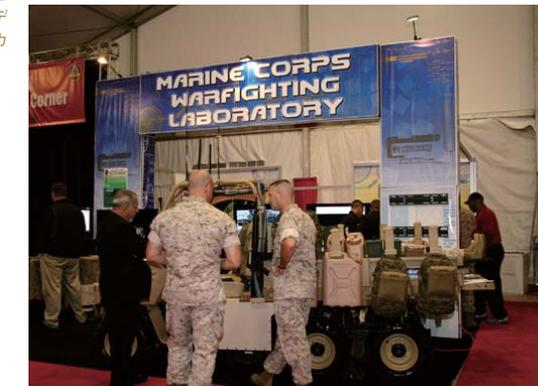
小型ロボット車輛であるGUSS (Ground Unmanned Support Surrogate: 地上無人支援代行車輛) は海兵戦闘研究所 (MCWL) のメインの「出し物」である。MCWL、海軍研究部 (ONR)、国防先進研究計画局 (DARPA) とも協力して進められているGUSSは、海兵、退役海兵、技術者、発明家などの合同チームを中心として進められている。基本的にはメカニカル・ミュール (機械化ロウ) の発展型であり、歩兵部隊に自動的に随伴してくれる荷役ロボットとして開発されている。
