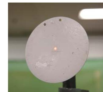
前回のモノよりも精度の上がった改良型発光プレート。BB弾がヒットすると、その衝撃により中央のLEDが点灯する。点灯は数秒で消えるので、射撃中にもほとんど気にならない。
