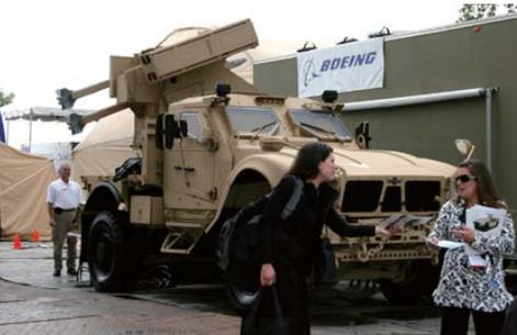
ボーイング社が大々的に展示した新型の軽量型防空システム。かつては、この種の車輛は巨大な装軌式車輛であったが、近年は軽車輛タイプであることが多い。これは機動性の面と価格面の要求による。緑色のトレーラーはその訓練シミュレータで、実際に参加者が操作できるようにしていた。
