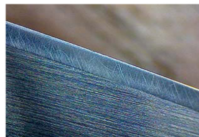
刃物職人が手研ぎで仕上げた出荷状態の鯭サキの小刃。小刃の先端に糸刃（先端を深い角度で研いだ刃止め）が認められる。切れ味は非常に鋭く、刃持ちも良い。
