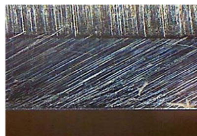
鍛冶屋が刃を研ぎ上げた出荷状態の小刃（約200倍）。斜めに浅い研ぎ傷が入っているが、切れ味は鋭い。斜めの研ぎ傷は手研ぎで仕上げた小刃の特徴だ。
