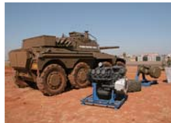
ハイブリッド駆動の開発は国営兵器会社であるアームスコとドイツのMM社 (現在は米L3社傘下) によって今世紀初頭から行なわれている。エンジンはMTU社の480kwの水冷ディーゼル、モーターは185kw。蓄電池は出力140kwのニッケル水素電池を採用している。
