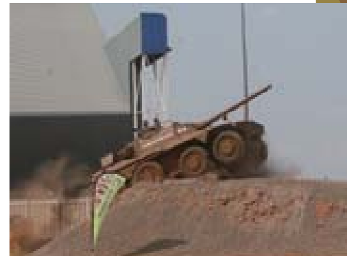
ハイブリッドの方式としては直接車輪をモーターで回す直列式となった。オリジナルのディーゼル駆動のロイカットとくらべても機動力は劣らない。静止から60km/hまでの加速は14秒で、600kmの航続距離を有している。
