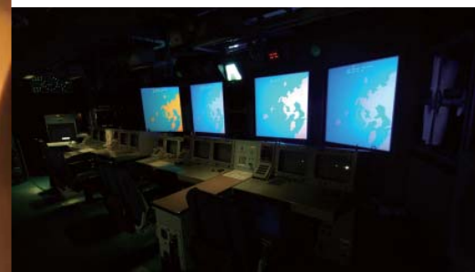
『こんごう』型の頭脳と言える戦闘指揮所：CIC（Combat Information Center）。レーダーによる敵の捕捉、ミサイルの射撃などすべてこの部屋で行なう。
