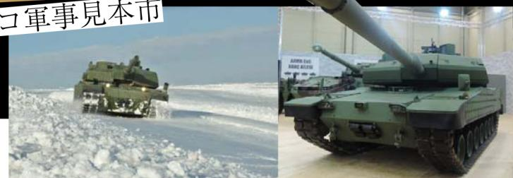
雪中試験中のアルタイ。今まで試作車輛は2輌製作され、各種の試験が行なわれている。さらに2輌の試作車が製造され、さらなる各種試験を2014年までに終了させ、2015年から生産に入る予定だという。なお生産数は250輌となっている。
