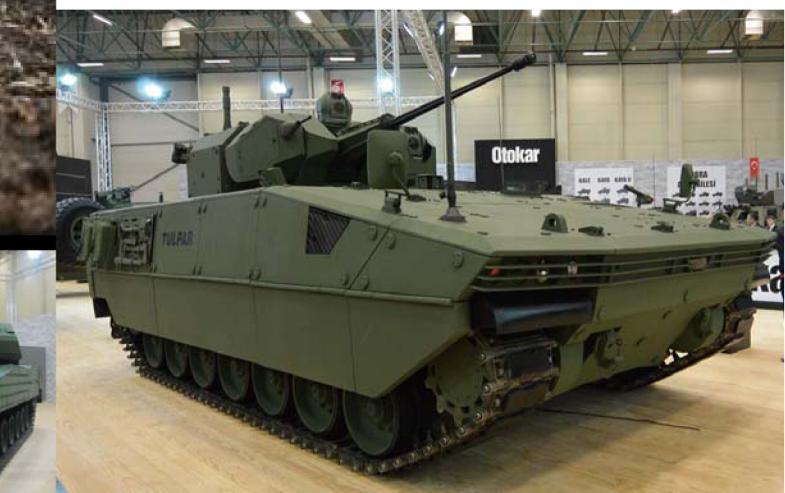
オトカ社の初の装軌式歩兵戦闘車「トルバ」。戦闘重量が32t (最大42tまでの増加が可能)。エンジンはスカニア社の810馬力ディーゼルエンジン、トランミッションはSAPA社のオートマチック・トランミッション「SG-850」を採用。砲塔は自社製の無人砲である「ミスマック30mm」を採用している。主砲は30mm機関砲で、同軸機銃は7.62mmだが主砲右側に別個コンボーネントとして装備されている。最高速度は70km/hで、戦闘重量32tの場合のパワー・ウェイト・レシオは25.3hp/tとなっている。登坂力は60%で航続距離は600km。なおエアコン、自動消火装置、NBCシステムは標準装備であり、全長7.23m、全幅3.4m、全高3.184m (車体のみは2.676m)。
