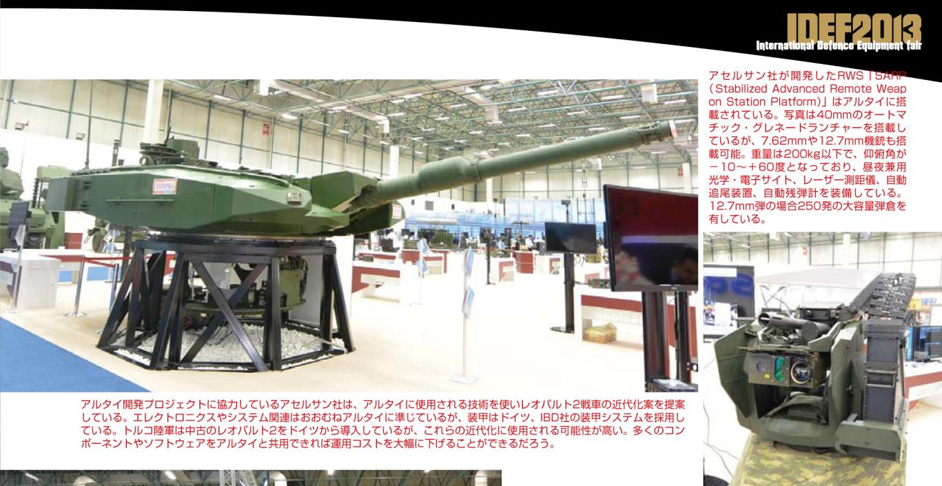
アルタイ開発プロジェクトに協力しているアセルサン社は、アルタイに使用される技術を使いレオパルト2戦車の近代化案を提案している。エレクトロニクスやシステム関連はおむねアルタイに準じているが、装甲はドイツ、IBD社の装甲システムを採用している。トルコ陸軍は中古のレオパルト2をドイツから導入しているが、これらの近代化に使用される可能性が高い。多くのコンポーネントやソフトウェアをアルタイと共に用いれば運用コストを大幅に下げることができるだろう。
