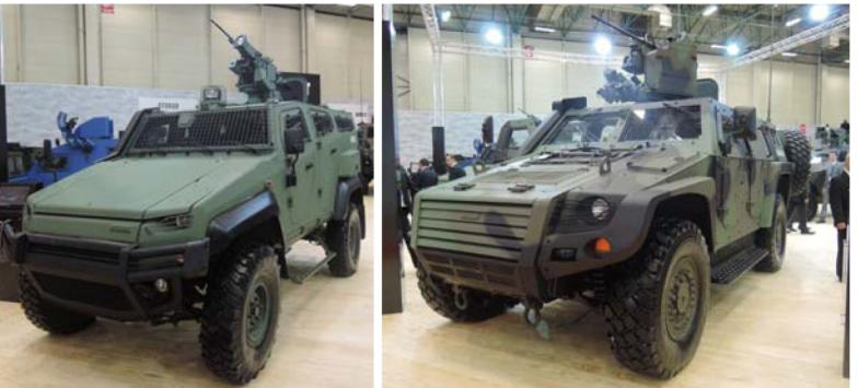
オトカ社の新型4輪装甲車「ウラルII」。戦闘重量は6.122t、エンジンは185馬力のディーゼルエンジンで、乗員は9名だが、最大10名まで搭乗が可能。車体はV字型の耐地雷下部構造を持ち、フローティング・シートを採用している。最高速度は110km/h、航続距離は600km、登坂力は60%。RESは自社製のバッテリーに7.62mm機銃とサーチライトを装備したモデル。
