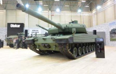
IDEFでは2輌製造されたアルタイの試作車のうち1輌が展示された。戦闘重量が約60t、主砲はライエンメタル社の55口径の120mm滑腔砲「L55」を採用。その他の主要コンポーネントの多くは国産開発されている。火器管制装置や通信システムなどはアセルサン社が担当しており、サーマルサイトなども国産である。バトル・マネジメント・システムはオトカ社が担当。また車体前後左右には状況把握用のビデオカメラが装備されている。開発に当たっては韓国のロテム社がアドバイザーという形で関わっているが、直接開発には関わっていない。
