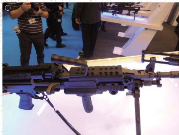
①バレル上部にはヒートシールドが設けられ、コッキングハンドルも改良されている。給弾は左右から可能で、200発用のポーチまたは箱型ケースに収容される。30連の小銃用マガジンも使用可能だ。なおフィードトレイには歯止めが設けられ、片手でも容易にヘルトリックを装着できる。②従来型と異なるパーツが黒色となっている。ハンドガードも変更が加えられ、左右、下部にレールマウントが装備されている。下部のレールマウントには起倒式のグリップが装備されている。バイポッドは取り外しができ、高さは3段階に調整が可能。既存のMINIMIをMk3にアップグレードするためのキットも発表されている。ちなみに陸自のMINIMIは筆者の知る限りオリジナルよりも総弾不良数が多いと現場では不満が多いようだ。
