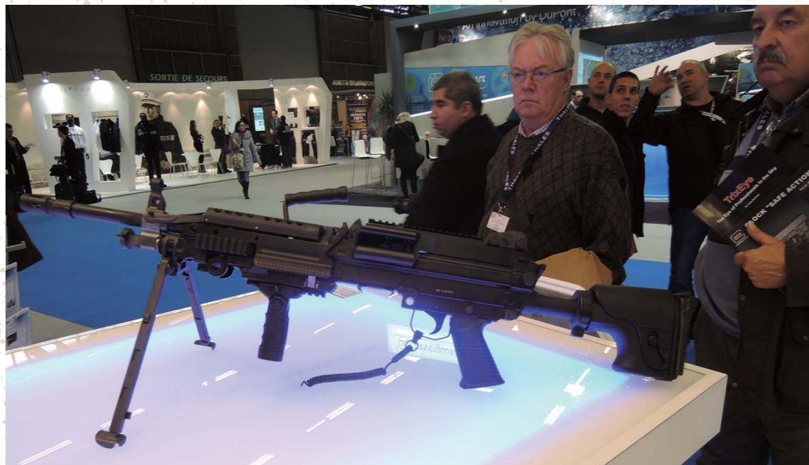
FN社のMINIMIの最新型“5.56mm MINIMI Mk3タクティカルSB”。全長863mm、バレル長349mm、重量8kg。SBのストックは5段階での伸縮が可能で、バックパッドの高さも調節できる。発射速度は800発/分で有効射程は800m。Mk3には写真のSBの他、固定銃床のスタンダード、タクティカルの派生型が存在する。
