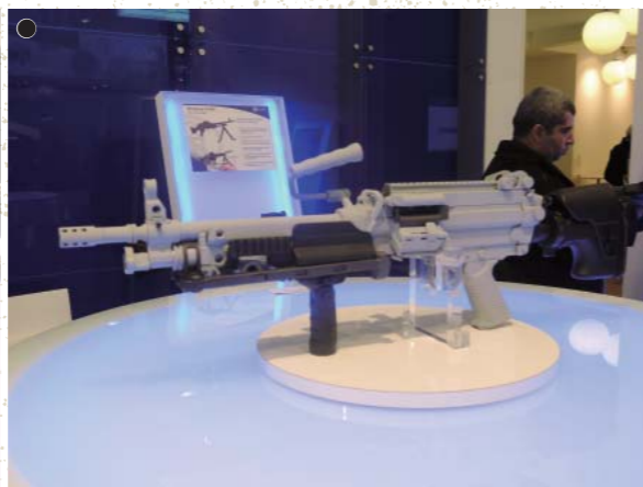
①バレル上部にはヒートシールドが設けられ、コッキングハンドルも改良されている。給弾は左右から可能で、200発用のポーチまたは箱型ケースに収容される。30連の小銃用マガジンも使用可能だ。なおフィードトレイには歯止めが設けられ、片手でも容易にヘルトリックを装着できる。②従来型と異なるパーツが黒色となっている。ハンドガードも変更が加えられ、左右、下部にレールマウントが装備されている。下部のレールマウントには起倒式のグリップが装備されている。バイポッドは取り外しができ、高さは3段階に調整が可能。既存のMINIMIをMk3にアップグレードするためのキットも発表されている。ちなみに陸自のMINIMIは筆者の知る限りオリジナルよりも総弾不良数が多いと現場では不満が多いようだ。
