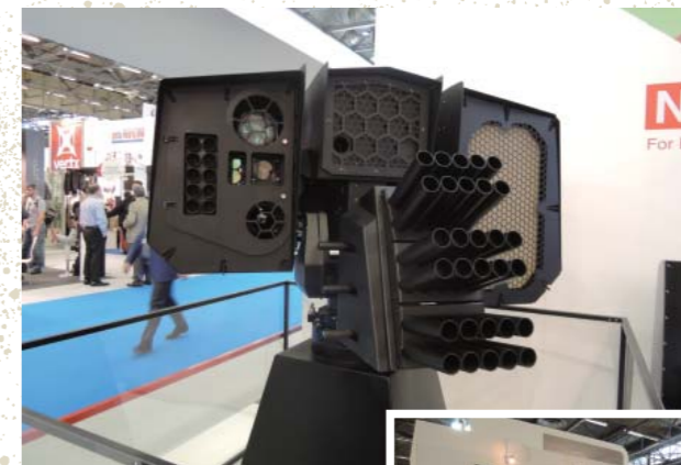
イスラエルのラファール社が開発したノンリーサル（非致命）のRWS“サムソンNR”。ライアット・コントロール用のRWSで、向かって左が指向性スピーカー兼音響兵器、中央が催涙ガスランチャー、左がストロボモードを有するサーチライト（メガレイ2175）、ゴム弾用のグレネードランチャーなどから構成されている。
