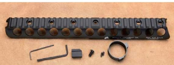
M870用として市販されているミドル・サイズのアクセサリー・レール。専用のバレル・リングとレール・ブロックで固定する。取り付けはいたって簡単だが、フォアグリップを少し加工しなければならない。
