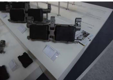
ディール社が発表したプーマ用の新型軽量履帯。クイック・フィット・バイヨネット方式により、履帯の装着がより迅速に行なえるようになり、またゴムパッドの交換も容易になったという。さらに振動や騒音も低減されているという。
