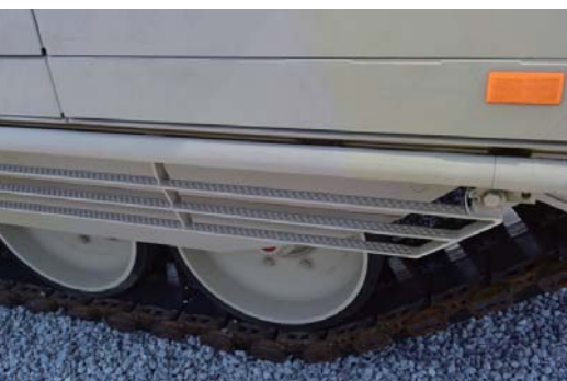
今回展示された車輻では車輪部にスカートと、さらにその外側に格子型装甲が追加されていた。格子型装甲の横のバーには重量軽減のために穴開けられている。A400M輸送機はペイロードが低下したが、プーマ搭載時にはこれら一部の増加装甲を取り外して輸送されるとのことだ。
