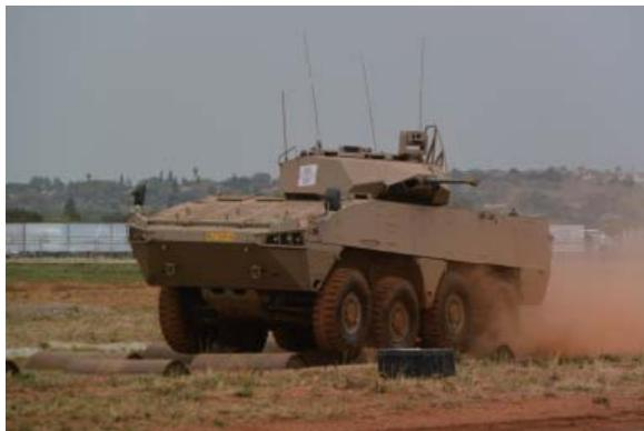
南ア陸軍の次期主力8輪装甲車バジャー。30mm砲を搭載した写真のICV型のほか、後装式の60mm迫撃砲や対戦車ミサイル搭載型など多くのファミリー型が存在する。
