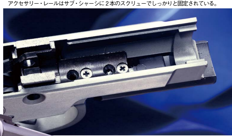
スクリューの位置を変更するとレールが前方に約5mm突き出す。これで市販アクセサリの多くに対応可能なサイズになる。
