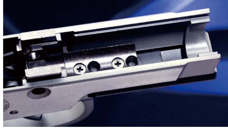
アクセサリ・レールはサブ・シャーシに2本のスクリューでしっかりと固定されている。
