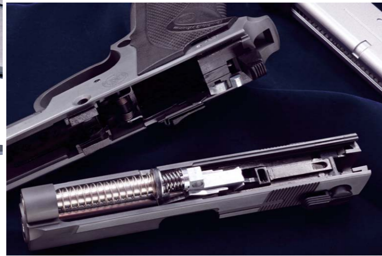
ダブル・タイプのリコイル・スプリング、強力なバッファー・スプリング、そしてラバー・バンパーなど。サブコンパクトらしいブローバック・スピードと強いキックを実現する様々な工夫が凝らされている。
