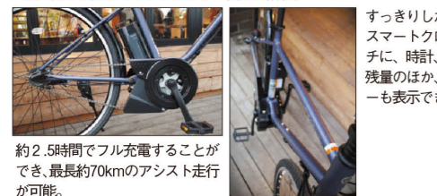
約2.5時間でフル充電することができ、最長約70kmのアシスト走行が可能。
