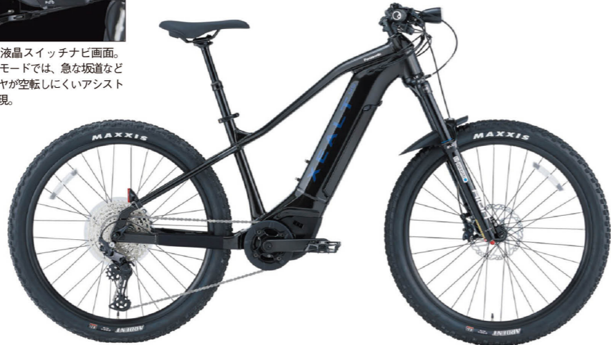
操作を集約したグリップ。フロントサスペンションは手でロックでき、舗装路走行時のパワーストレスを軽減可能。 GXモーター。3つのアシストモードを生み出す。
