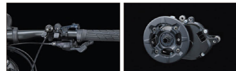
操作を集約したグリップ。フロントサスペンションは手でロックでき、舗装路走行時のパワーストレスを軽減可能。 GXモーター。3つのアシストモードを生み出す。
