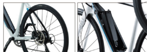
25Cの少し太めのタイヤが装着。ダウンチューブにバッテリーが内蔵され、デザイン性に優れている点も魅力。
